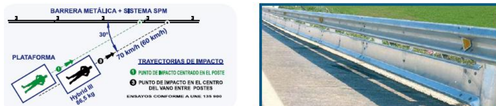
Figura 3.1. Barrera de contención de vehículos que también sirve para proteger a los motociclistas.
