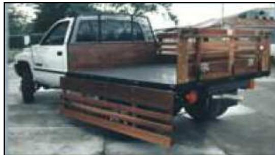
Fotografía de un adral. López et al, 2008, *Definición de carrocerías de la lista de valores de vehículos de la Dirección General de Tributación y asignación de la clasificación arancelaria*, p.3.
