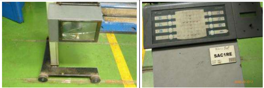
Fotografías 26- 27. Regloscopio SAC1RE con número de placa 2691 Serie 1595 tiene la lente quebrada.
