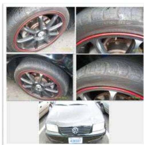
Vehículo placa 436507 presenta llantas unidireccionales instaladas de manera incorrecta.
