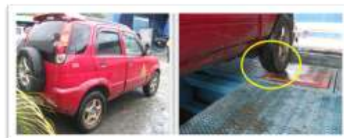
Llanta delantera derecha del vehículo placas TP 701 montada parcialmente sobre el piso de la estación mientras se realiza la prueba de suspensión.
